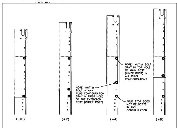
FIGURE 2-5: EXTENDED CONFIGURATION - SIDE VIEWS
