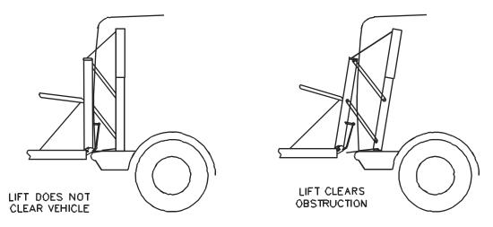
FIGURE 2-15: LIFT OPERATING CLEARANCE
