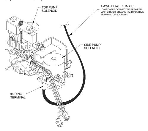
FIGURE 2-6: POWER CABLE CONNECTION TO SOLENOID
