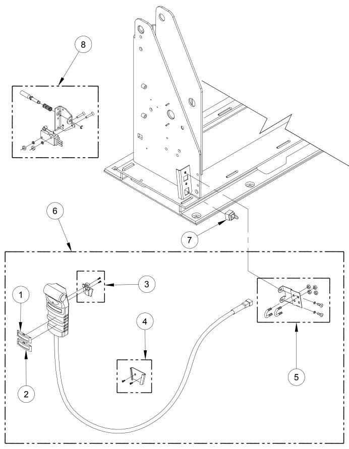
FIGURE 4-5: SLIDE-AWAY PENDANT AND DOOR INTERLOCK SWITCH
