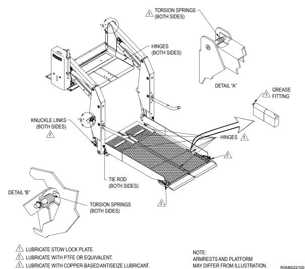
FIGURE 3-1: LIFT LUBRICATION POINTS
