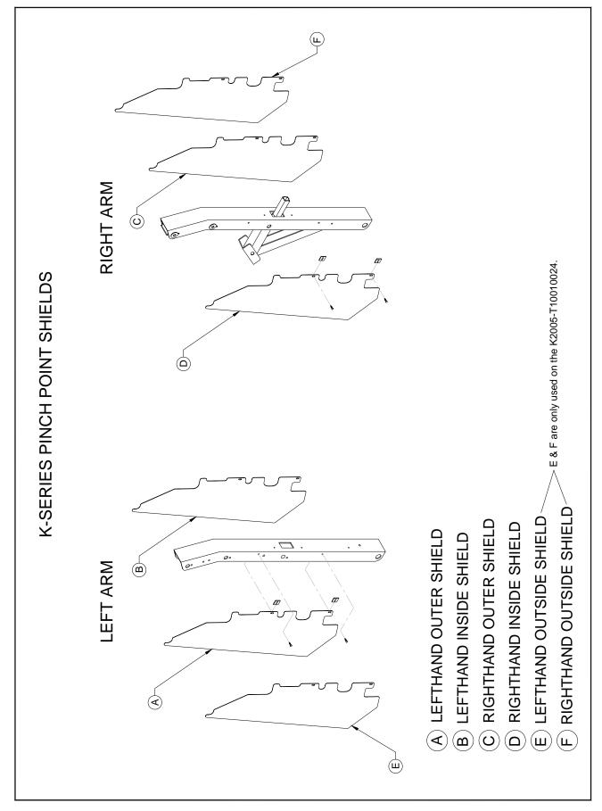
**FIGURE 4-13: PINCH POINT SHIELDS**
