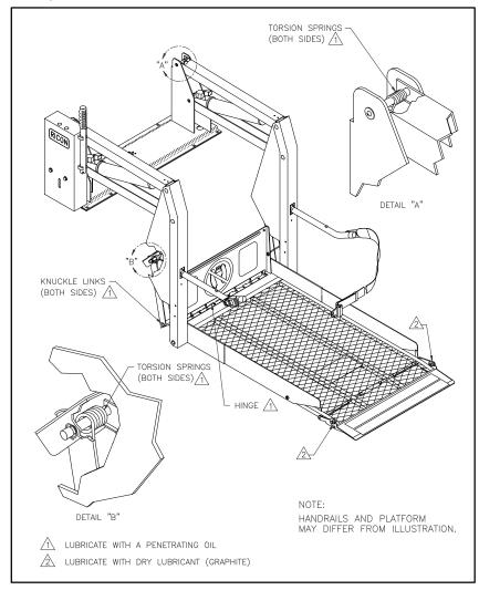
FIGURE 3-1: LIFT LUBRICATION POINTS
