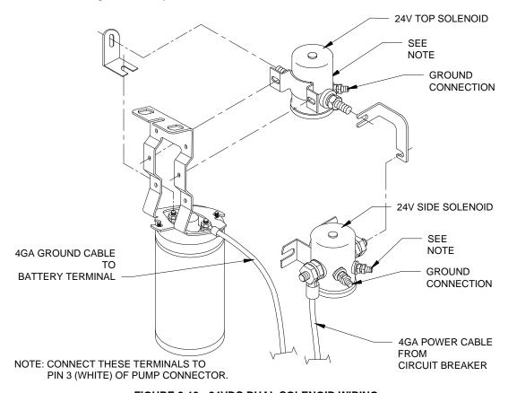
FIGURE 2-13: 24VDC DUAL SOLENOID WIRING
